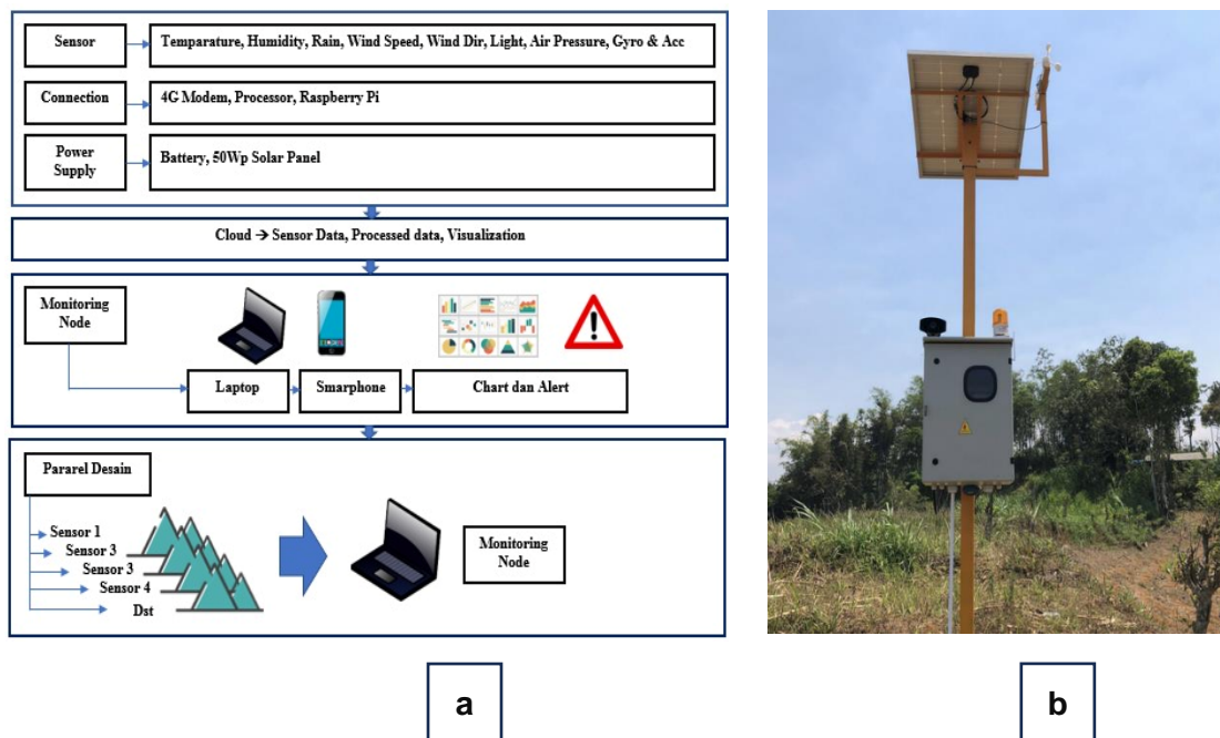
Gambar 4: a) framework kerja; b) Installasi CoL-Ways di salah satu titik longsor di Kabupaten Trenggalek
